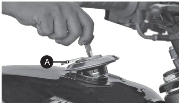
Para abrir a tampa do tanque de combustível, afaste a tampa de proteção (A) de sua posição. Insira a chave na fechadura e gire-a no sentido horário. A tampa do tanque é ejetada automaticamente. Retire a tampa junto com a chave.
