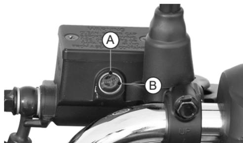
3. Se o nível do fluido de freio estiver abaixo da marca ou quando utilizar o freio e sentir uma ineficiência do freio, entre em contato com uma Assistência Técnica Autorizada para verificação. Para completar o fluido de freio, sangrar o freio e inspecionar o sistema por completo.
