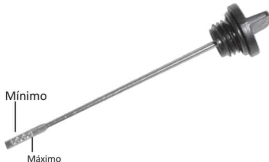
5. O nível de óleo deve estar entre as marcas de nível mínimo e máximo do medidor, conforme mostrado.
